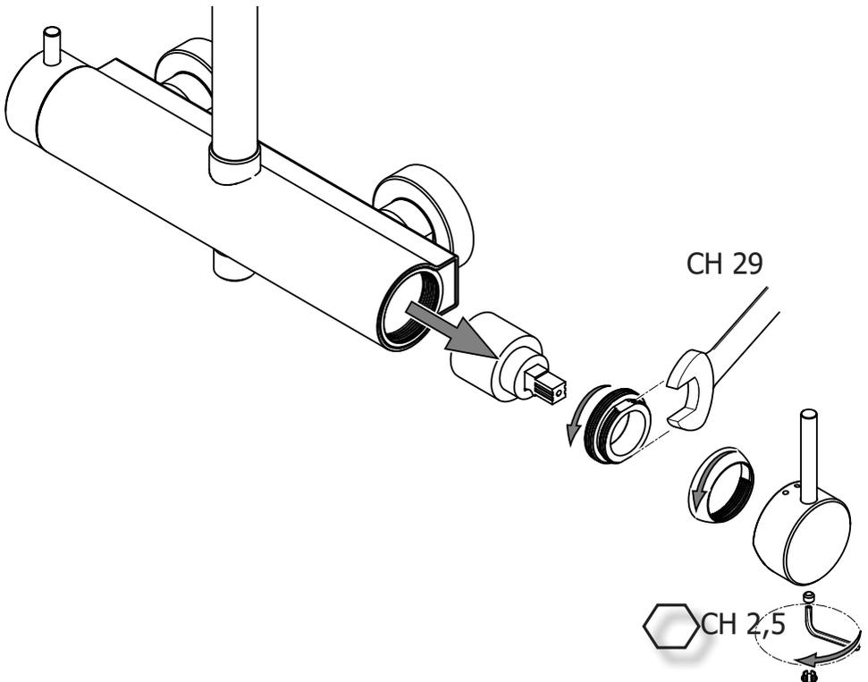
**b** Sostituzione Sede Calotta
