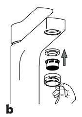
Sostituzione Aeratore How to replace Aerator
